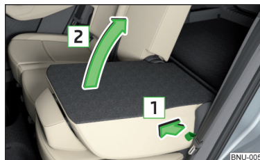
Obr. 94 Narovnání zádové opěry
