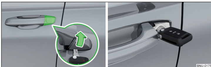
Obr. 332 Klikla dveří řidiče: odklopení krytu zámku / vložka zámku s klíčem
