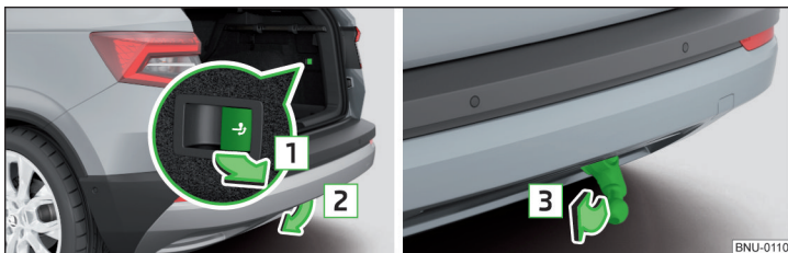
Obr. 296 Tažné rameno: vyklopení
