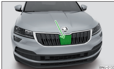
Obr. 256 Umístění radarového snímače
