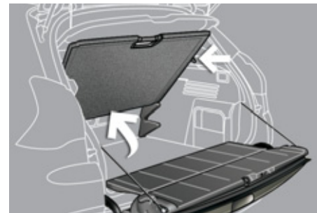
Z horní polohy: pro přístup pod podlážku nebo k rezervnímu kolu umístěte podlážku do této polohy (našikmo), dva dorazy ji budou v dané poloze zajišťovat.
