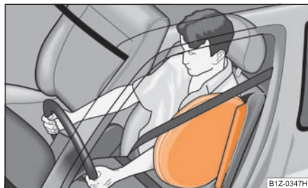
Obr. 182 Plynem naplněný boční airbag
