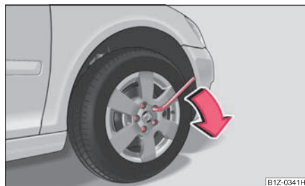
Obr. 227 Výměna kola: povolení šroubů
