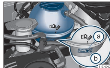
Obr. 213 Motorový prostor: nádržka chladicí kapaliny
