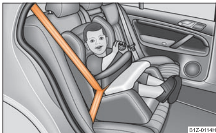
Obr. 191 Dětská sedačka skupiny 1 s bezpečnostním stolem na zadním sedadle po směru jízdy
