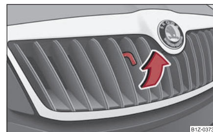
Obr. 15 Mřížka chladiče: páka pojistky
