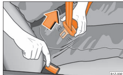
Obr. 176 Uvolnění jazyčku pásu ze zámku
