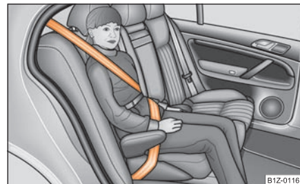
Obr. 193 Dětská sedačka skupiny 3 umístěná na zadním sedadle po směru jízdy
