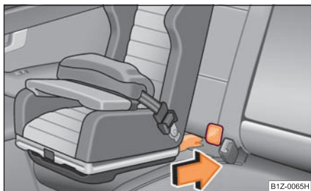
Obr. 195 Dětská sedačka ISOFIX se zasune do montážních krytů
