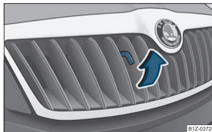
Obr. 209 Mřížka chladiče: páka pojistky
