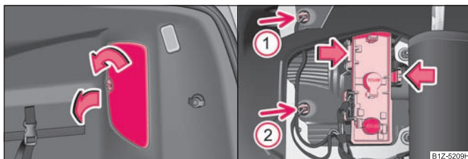
Obr. 197 Zavazadlový prostor: kryt držáku žárovek / Demontáž držáku žárovek
