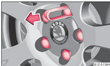
Obr. 176 Stažení krytky šroubu kola
