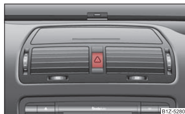
Obr. 42 Přístrojová deska: spínač varovných světel
