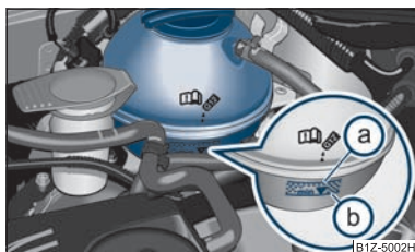
Obr. 164 Motorový prostor: nádržka chladicí kapaliny
