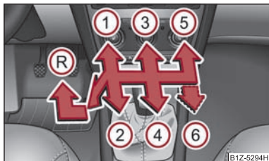
Obr. 112 Schéma řazení 5. popř. 6stupňové převodovky
