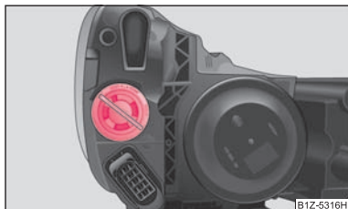
Obr. 191 Demontáž žárovky předního směrového světla
