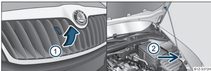
Obr. 161 Mřížka chladiče: páka pojistky / Zajištění víka motorového prostoru vzpěrou
