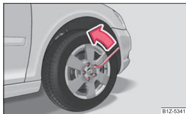
Obr. 178 Výměna kola: povolení šroubů
