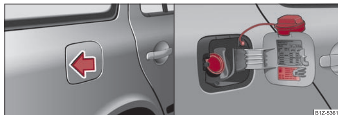
Obr. 11 Boční strana vozidla vpravo vzadu: otevření krytu palivové nádrže / Kryt palivové nádrže s odšroubovaným uzávěrem
