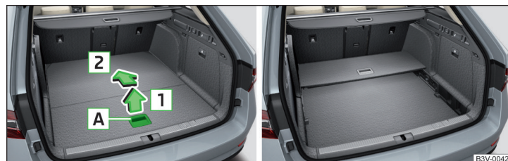
Obr. 161 Složení mezipodlahy / Složená mezipodlaha v horní poloze
