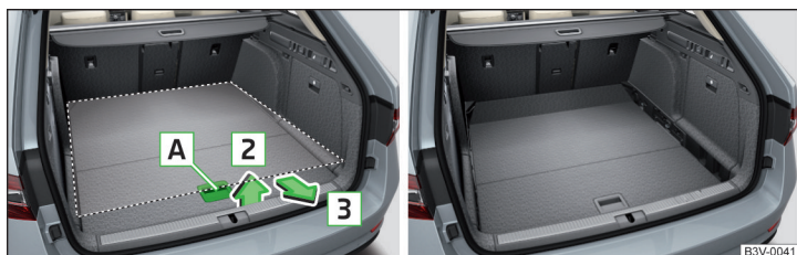
Obr. 160 Nastavení mezipodlahy do dolní polohy / Mezipodlaha v dolní poloze
