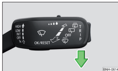
Obr. 352 Nastavení servisní polohy stěračů
