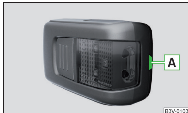
Obr. 346 Západka krytu akumulátorů
