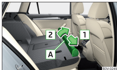
Obr. 165 Vyjmutí kazety dělicí sítě
