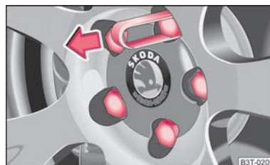
Obr. 186 Stažení krytky šroubu kola
