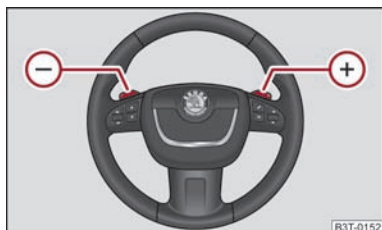
Obr. 129 Multifunkční volant: ruční řazení
