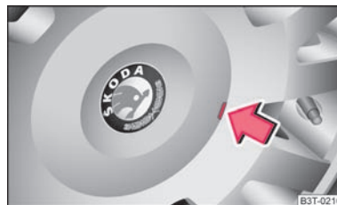
Obr. 187 Stažení ozdobného krytu u kol z lehkých slitin
