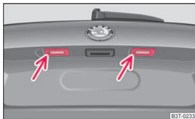
Obr. 211 Víko zavazadlového prostoru: osvětlení registrační značky
