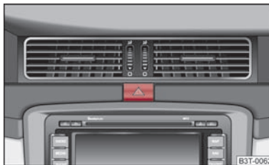
Obr. 39 Přístrojová deska: spínač varovných světel
