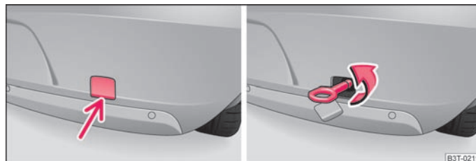
Obr. 197 Zadní nárazník: demontáž krytky / Montáž vlečného oka
