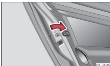
Obr. 12 Dětská pojistka zadních dveří
