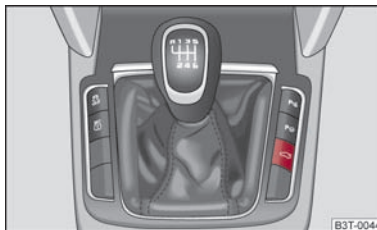
Obr. 21 Ovládání víka - tlačítko na středové konzole
