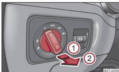
Obr. 36 Přístrojová deska: spínač světel
