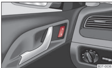
Obr. 13 Spínač centrálního zamykání
