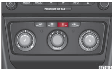
Obr. 112 Tlačítko pro přímé zapnutí (vypnutí) nezávislého přídavného topení a větrání na panelu ovládání klimatizace ►
