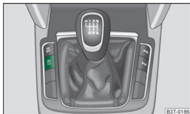
Obr. 163 Spínač nastavení kontrolní hodnoty tlaku v pneumatikách
