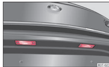
Obr. 210 Zadní nárazník: osvětlení registrační značky
