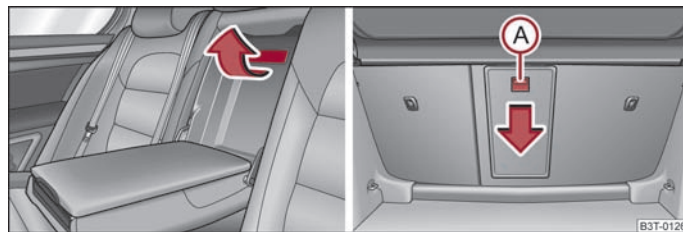
Obr. 103 Zadní sedadla: madlo víka / Zavazadlový prostor: odjišťovací tlačítko
