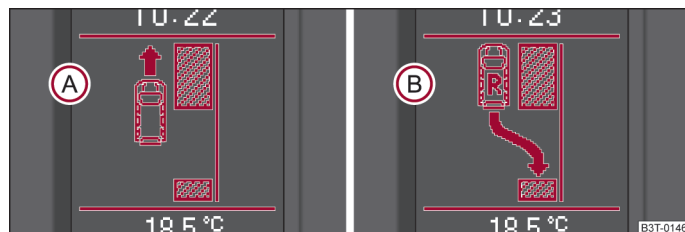
Obr. 123 Informační displej: mezera pro zaparkování zjištěna s pokynem pro pokračování v jízdě vpřed (A) a pro zařazení zpětného chodu (B)
