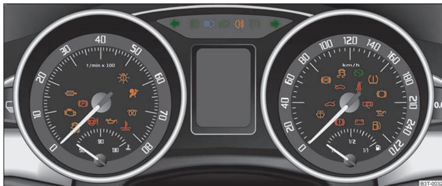
Obr. 9 Sdružený panel přístrojů s kontrolními světly
