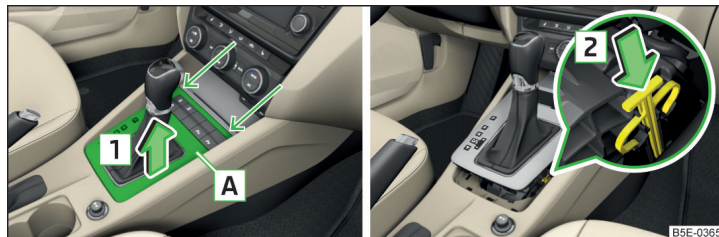
Obr. 224 Vyjmutí krytu / Odblokování volicí páky
