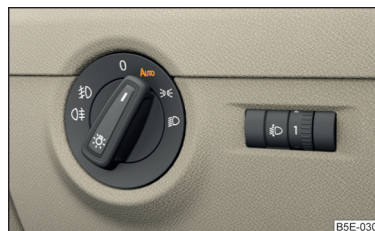
Obr. 46 Spínač světel: poloha AUTO
