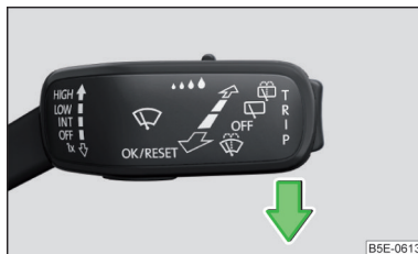
Obr. 225 Nastavení servisní polohy stěračů
