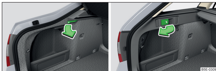
Obr. 67 Sklopení zádové opěry ze zavazadlového prostoru: varianta 1 / varianta 2
