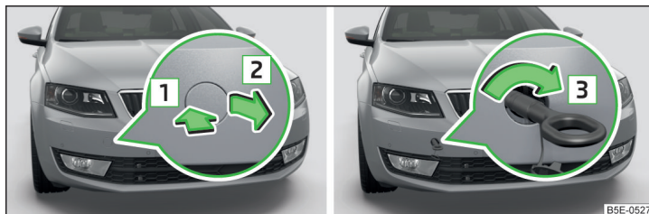
Obr. 216 Vyjmutí krytky / Montáž vlečného oka
