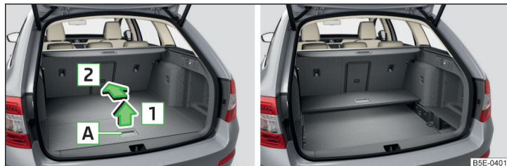
Obr. 119 Složení mezípodlahy / Složená mezípodlaha v horní poloze
