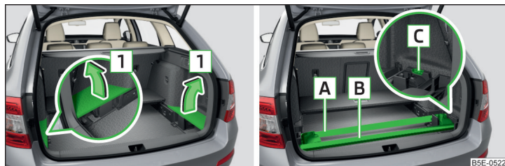
Obr. 125 Vyjmutí bočních krytů zavazadlového prostoru / Uložení střešních nosičů
