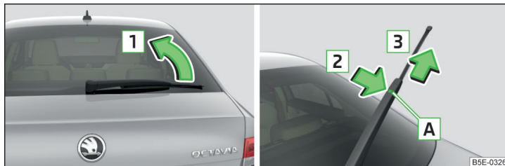
Obr. 227 Výměna stírací lišty zadního skla
