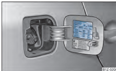
Obr. 157 Otevřený kryt palivové nádrže s tabulkou rozměrů a tlaků v pneumatikách
