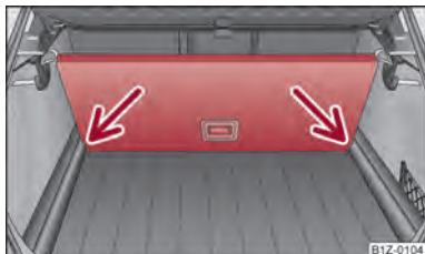
Obr. 61 Zavazadlový prostor: přepažení pomocí mezipodlahy
