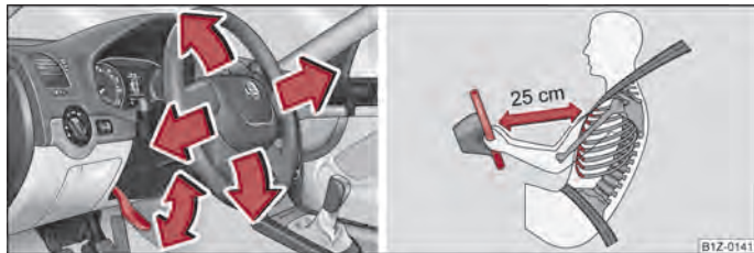
Obr. 98 Nastavitelný volant: páčka pod volantem / bezpečná vzdálenost od volantu
