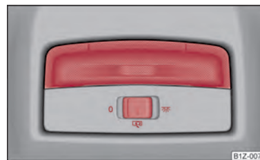
Obr. 32 Vnitřní osvětlení vozidla - provedení 2
