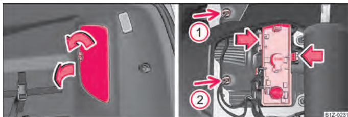
Obr. 189 Zavazadlový prostor: kryt držáku žárovek / Demontáž držáku žárovek
