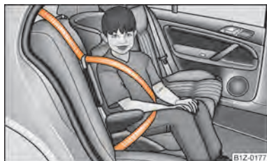
Obr. 134 Dětská sedačka skupiny 2 umístěná na zadním sedadle po směru jízdy
