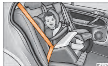
Obr. 133 Dětská sedačka skupiny 1 s bezpečnostním stolem na zadním sedadle po směru jízdy
