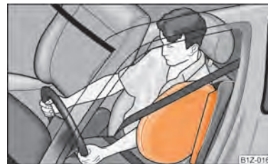
Obr. 126 Plynem naplněný boční airbag
