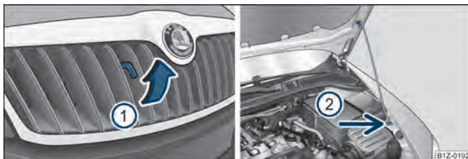
Obr. 149 Mřížka chladiče: páka pojistky / Zajištění víka motorového prostoru vzpěrou
