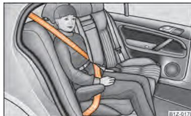
Obr. 135 Dětská sedačka skupiny 3 umístěná na zadním sedadle po směru jízdy
