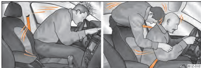
Obr. 118 Nepřipoutaný řidič je vržen dopředu / Nepřipoutaný spolujezdec ze zadního sedadla je vržen dopředu
