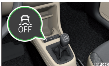
Obr. 129 Tlačítko systému City Safe Drive
