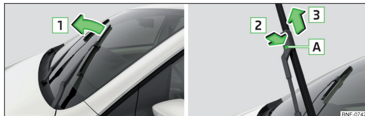
Obr. 162 Výměna stírací lišty čelního skla
