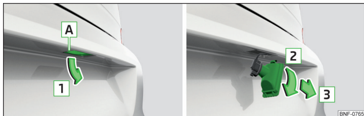
Obr. 178 Vyjmutí osvětlení registrační značky
