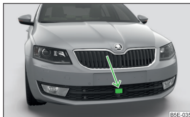
Obr. 148 Umístění radarového snímače
