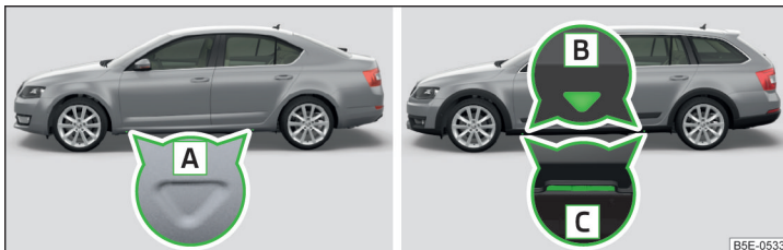
Obr. 201 Upínací body pro nasazení zvedáku vozidla: varianta 1 / varianta 2
