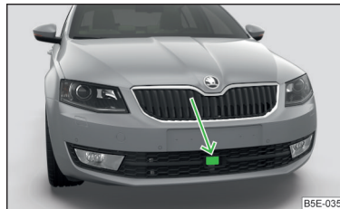
Obr. 154 Umístění radarového snímače
