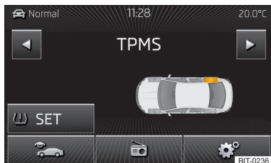
Obr. 164 Tlačítko pro uložení tlaků / Příklad zobrazení na displeji: sys- tém upozorňuje na změnu tlaku v pravé zadní pneumatice
