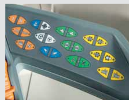
Nejjednodušší a zároveň užitečné jsou automatické funkce jako automatika předního či zadního zvedacího zařízení, stejně tak i automatika spouštění a vypínání předního nebo zadního vývodového hřídele. K tomu se využívají tlačítka Go a End na multifunkčním joysticku.
