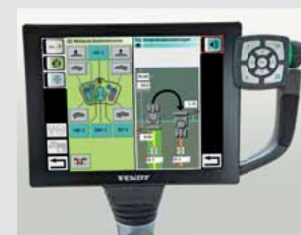
Funkce pro ovládání nářadí a souvratový management je možné podle potřeby přiřadit k multifunkční páce. Řidič si tak může nastavit nejlepší ergonomické ovládání podle svých potřeb. Systém Variotronic TI umožňuje, v kombinaci se systémem automatického řízení VarioGuide, automatickou aktivaci různých sekvencí na souvratích.
