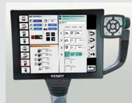
Pro perfektní sled jednotlivých kroků se tyto nechají nastavit i v klidu během stání traktoru. Pokud je potřeba, může pak řidič během práce nastavení upravit nebo změnit.
