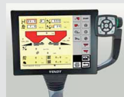
Ovládání nářadí ISOBUS je dokonale integrované do Varioterminálu 7" a Varioterminálu 10,4-B (neplatí pro verzi Power).. Nářadí je ovládáno pomocí terminálu a joysticku, takže další terminál není zapotřebí. Při zobrazení na celou obrazovku se z Varioterminálu stane plnohodnotný terminál ISOBUS.
