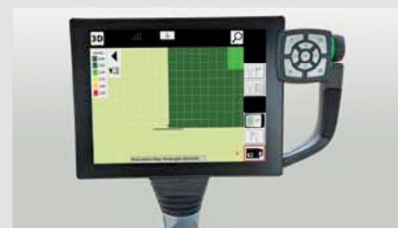
Nová variabilní regulační funkce je nyní k dispozici v kombinaci s VarioDoc Pro. Požadavky na osivo, hnojivo a pesticidy jsou uloženy v dávkovacích mapách v závislosti na složení půdy, poté nahrány do terminálu a vyvolávány během práce. Stupeň dávkování lze ovládat automaticky. Příště pak lze požadované pracovní vstupy přesně reprodukovat a upravit pro budoucí využití.
