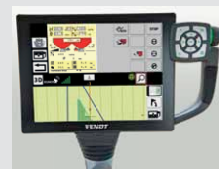
Jednoduché, přehledné a srozumitelné ovládání pro automatické vypínání sekcí SectionControl, které je součástí Varioterminálu. Přehledněji to snad už nejde.
