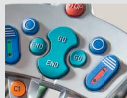
Tlačítka na multifunkční pojezdové páce můžete obsadit jednotlivými operacemi a využít je pro nahrané funkce v souvratovém managementu – např. vjetí a vyjetí do řádku.
