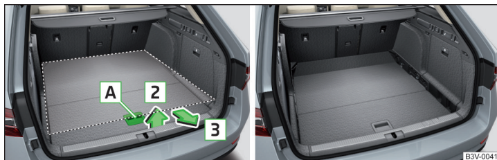
Obr. 140 Nastavení mezipodlahy do dolní polohy / Mezipodlaha v dolní poloze
