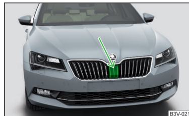
Obr. 264 Umístění radarového snímače
