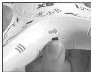
Krok3: zavřete kryt baterie a zapněte kvadroptéru.
