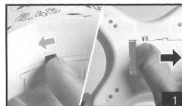
1. Vypněte kvadroptéru a otevřete kryt baterie.
