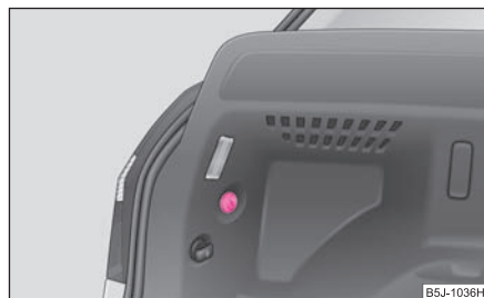
Obr. 205 Demontáž zadní skupinové svítilny
