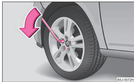
Obr. 185 Výměna kola: povolení šroubů
