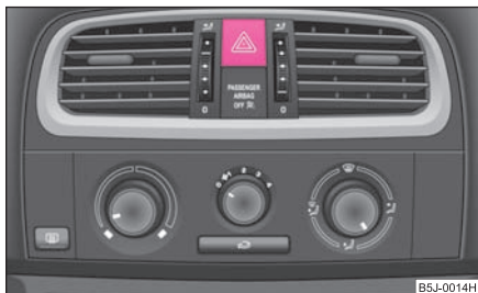
Obr. 37 Přístrojová deska: spínač varovných světel
