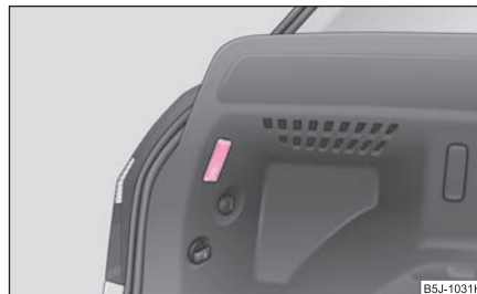
Obr. 208 Demontáž osvětlení zavazadlového prostoru
