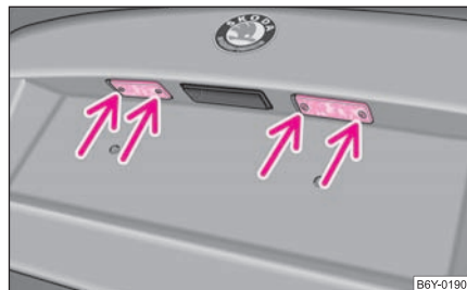
Obr. 204 Demontáž osvětlení registrační značky
