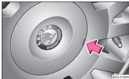
Obr. 192 Výměna kola: stažení ozdobného krytu
