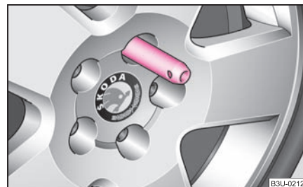
Obr. 197 Výměna kola: montážní přípravek
