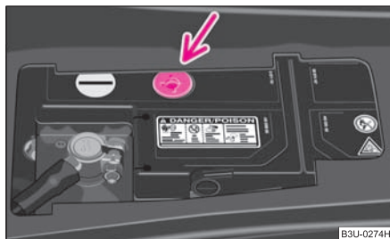
Obr. 179 Motorový prostor: akumulátor s magickým okem
