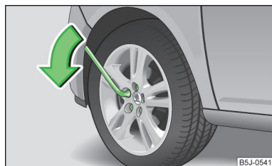
Obr. 141 Výměna kola: povelení šroubů
