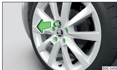
Obr. 272 Stažení krytky šroubu kola
