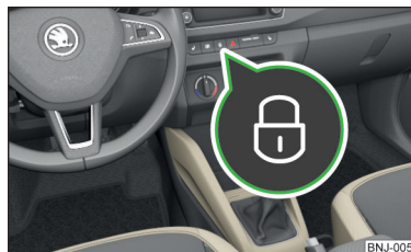
Obr. 45 Spínač centrálního zamykání
