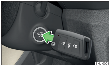
Obr. 207 Startování motoru - stisknutí tlačítka klíčem
