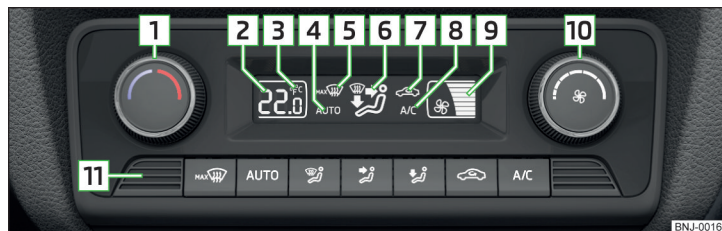
Obr. 125 Ovládací prvky Climatronicu
