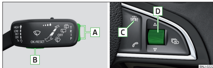
Obr. 239 Tlačítka: na ovládací páčce / na multifunkčním volantu
