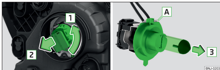
Obr. 303 Výměna žárovky dálkového světla
