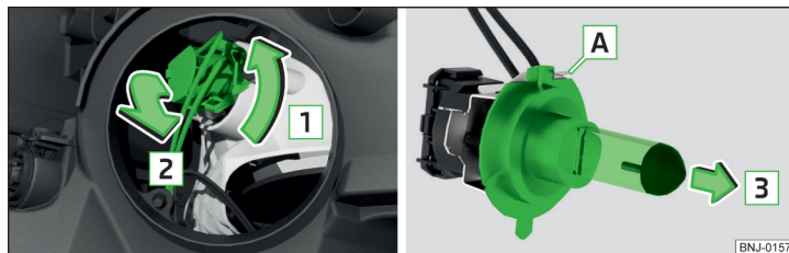
Obr. 302 Výměna žárovky potkávacího světla
