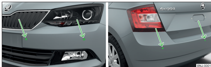
Obr. 219 Umístění snímačů na levé straně vozidla: vpředu/vzadu
