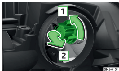
Obr. 301 Výměna žárovky předního směrového světla
