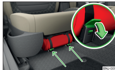
Obr. 269 Uvolnění hasicího přístroje
