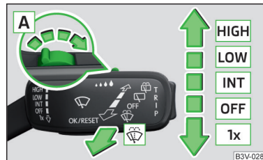
Obr. 64 Ovládání stěračů a ostříkovačů čelního skla
