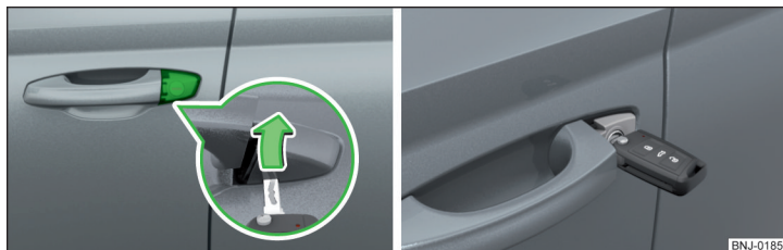
Obr. 283 Klikla dveří řidiče: odklopení krytu zámku / vložka zámku s klíčem
