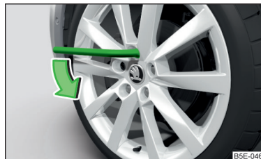
Obr. 274 Povolení šroubů kola
