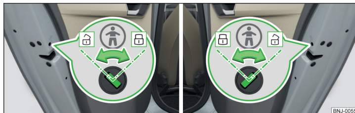
Obr. 48 Zadní dveře: zapnutí / vypnutí dětské pojistky
