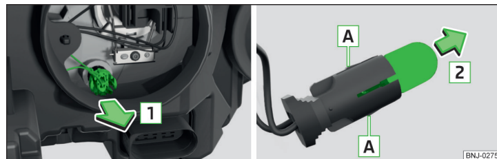
Obr. 300 Výměna žárovky obrysového světla
