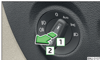
Obr. 57 Spínač světel - zapnutí mlhových světel
