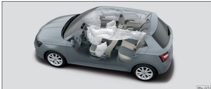
Obr. 20 Plynem naplněné airbagy
