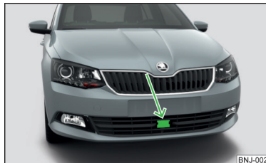
Obr. 217 Umístění radarového snímače
