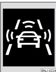
Obr. 238 Displej v panelu přístrojů: předběžné varování, resp. nouzové brzdění v nízké rychlosti
