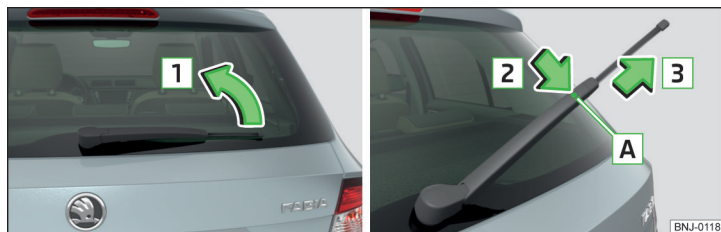
Obr. 289 Výměna stírací lišty zadního skla
