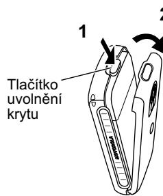
2 Tažením horní části zadního krytu telefonu směrem dolů kryt sejměte.
