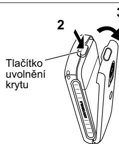
3 Tažením horní části zadního krytu telefonu směrem dolů kryt sejměte.
