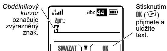
Po dvou sekundách se kurzor změní na blikající a posune se na následující pozici.
