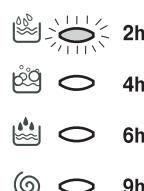
Po uplynutí zvoleného času dôjde k zhasnutiu kontrolky odloženého štartu a k zahájeniu nastaveného pracieho programu.
