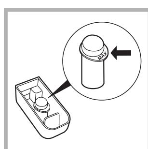
Mitgelieferte, zusätzliche Kammer 4 in Kammer 1 einsetzen. Bei der Dosierung des Bleichmittels darf der auf dem Zentralstift mit "max" gekennzeichnete Höchststand (siehe Abbildung) nicht überschritten werden.
