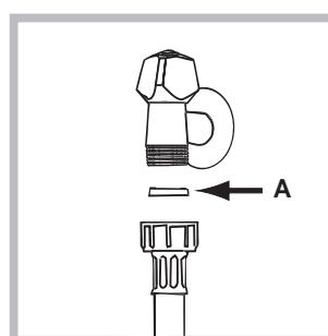
1. Inserire la guarnizione A nell'estremità del tubo di alimentazione e avitarlo a un rubinetto d'acqua fredda con bocca filettata da 3/4 gas (vedi figura). Prima di allacciare, far scorrere l'acqua finché non sia limpida.
