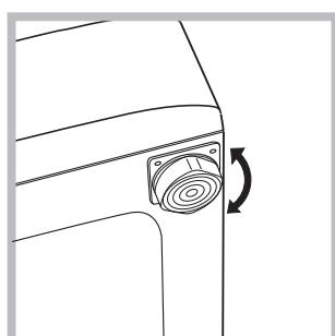
2. V případě, když podlaha není dokonale vodorovná, mohou být případné rozdíly vykompenzovány šroubováním předních nožek (viz obrázek). Úhel sklonu, naměřen na pracovní ploše, nesmí přesáhnout 2°.
