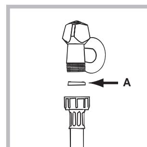
1. Legen Sie die Gummidichtung A in das Anschlussstück des Zulaufschlauches ein und drehen Sie dieses an einen mit Gewindeanschluss von  $\frac{3}{4}$  G versehenen Kaltwasserhahn (siehe Abbildung). Lassen Sie das Wasser vor dem Anschluss so lange auslaufen, bis klares Wasser austritt.
