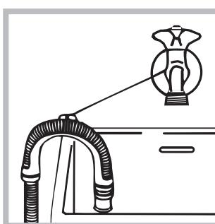
oder hängen Sie ihn in ein Becken oder eine Wanne ein; befestigen Sie ihn in diesem Falle mittels der mitgelieferten Führung an dem Wasserhahn (siehe Abbildung). Das freie Ablaufschlauchende darf nicht unter Wasser bleiben.
