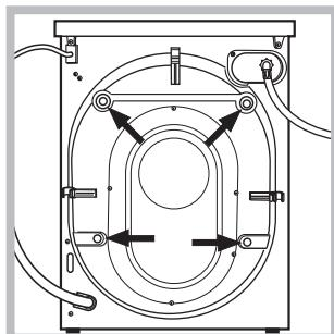
3. Die 4 Transportschutzschrauben ausschrauben und das an der Rückwand befindliche Gummiteil nebst entsprechendem Distanzstück abnehmen (siehe Abbildung).
