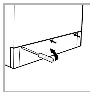
1. Die Abdeckung (befindlich an der Gerätefront) mit Hilfe eines Schraubenziehers abnehmen (siehe Abbildung);
