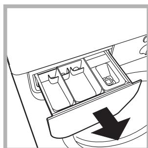
Vytiahnite dávkovač jeho nadvihnutím a vytiahnutím smerom von (vid' obrázok). Umyte ho pod prúdom vody; tento druh vyčistenia je treba vykonávať pravidelne.
