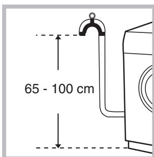
Připojte vypouštěcí hadici, k odpadovému potrubí anebo k odpadu ve stěně, nacházejícímu se od 65 do 100 cm nad zemí; zamezte jejímu ohybu;
