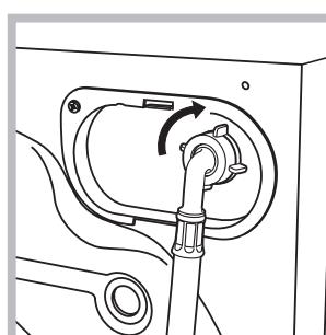
2. Συνδέστε το σωλήνα τροφοδοσίας στο πλυντήριο βιδώνοντάς το στην αντίστοιχη είσοδο νερού, στο πίσω μέρος επάνω δεξιά (βλέπε εικόνα).
