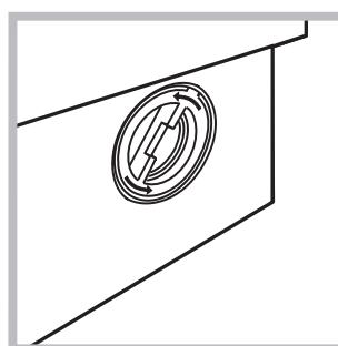
2. odšroubujte vrchní kryt otáčením proti směru hodinových ručiček (viz obrázek): vytěčení malého množství vody je zcela běžným jevem;
