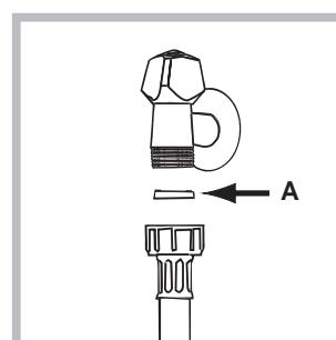
1. Vložte tesnenie A do koncovej časti prítokovej hadice a pripojením ju k uzáveru studenej vody so závitom 3/4" (vid' obrázok). Pred pripojením hadice nechajte vodu odtieť, až kým nebude priezračná.
