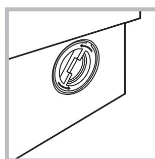
2. odkrúťte vrchný kryt jeho otáčaním proti smeru hodinových ručičiek (vid' obrázok): vytiečenie malého množstva vody je celkom bežným javom;
