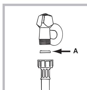
1. Εισάγετε την τσιμούχα Α στο άκρο του σωλήνα τροφοδοσίας και βιδώστε τη μια βρύση κρύου νερού με στόμιο σπιερώματος 3/4 gas (βλέπε εικόνα). Πριν την σύνδεση αφήστε το νερό να τρέξει μέχρι αυτό να είναι διαυγές.
