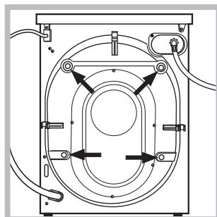
3. Odstraňte čtyři šrouby s gumovou podložkou a s příslušnou rozpěrkou, nacházející se v zadní části (viz obrázek), sloužící na ochranu během přepravy.
