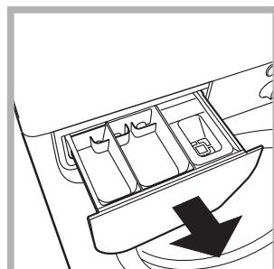
Vytáhněte dávkovač jeho nadzvednutím a vytáhnutím směrem ven (viz obrázek). Umyjte ho pod proudem vody; tento druh vyčištění je třeba vykonávat pravidelně.
